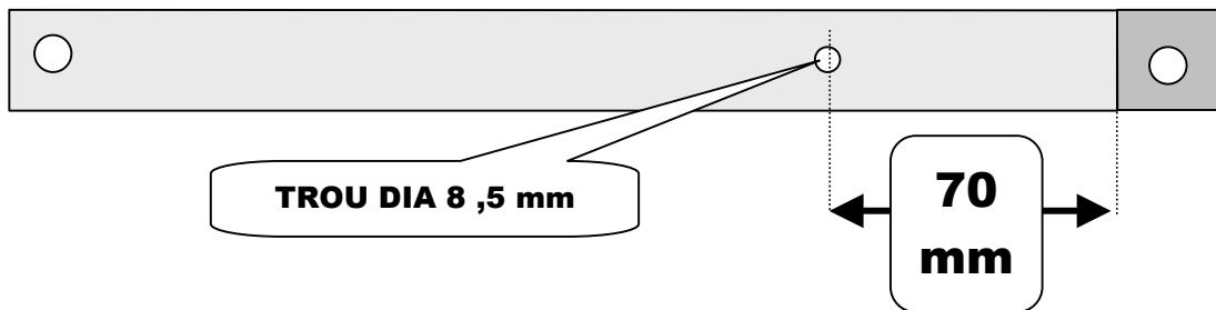
GLISSER L'INSERT DANS LE TUBE ET LE FIXER AVEC LA VIS DE 8 x 16
