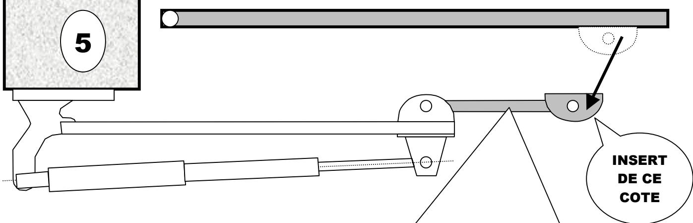
**MONTER LA BIELLETTE SUR LE PANTOGRAPHHE**
