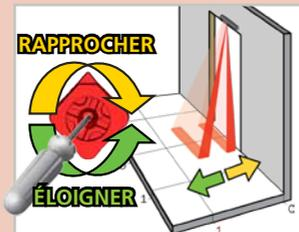
Si nécessaire, ajustez l'angle du rideau IRA (de  $-7^\circ$  à  $4^\circ$ ).
