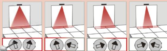
Une partie du champ d'émission peut être masquée afin de réduire la zone de détection. La position de la flèche détermine la largeur du champ IR.
