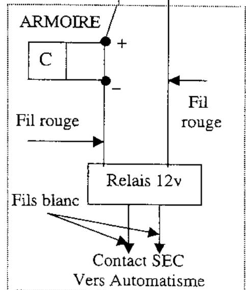
Connecter le condensateur C(2200 $\mu$ F/35v) a la borne L de la platine de rue et au Fil rouge du relais en respectant la polarité :
