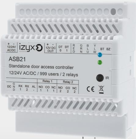
► Programmation par télécommande infrarouge ou clavier AXK3, AXK4 et ASK2.
