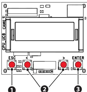
Hors du menu, la touche ESC provoque l'arrêt du portail tandis que les touches < > permettent d'obtenir l'ouverture et la fermeture du portail.
